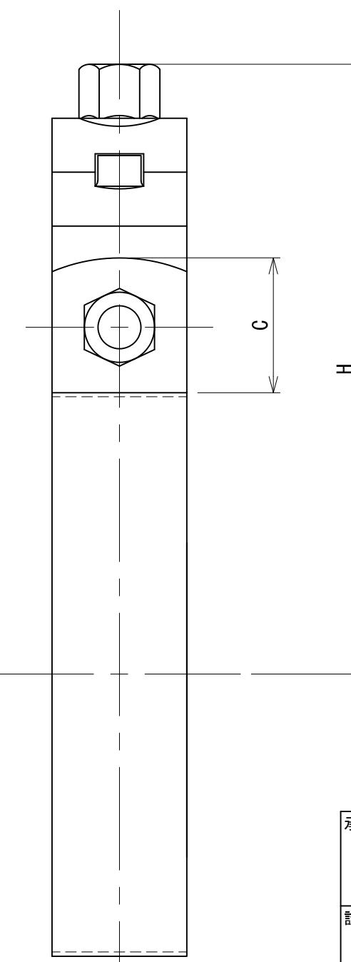
※本体:ステンレス製(SUS430),タンバックル・ボルトナットは鉄製です。
