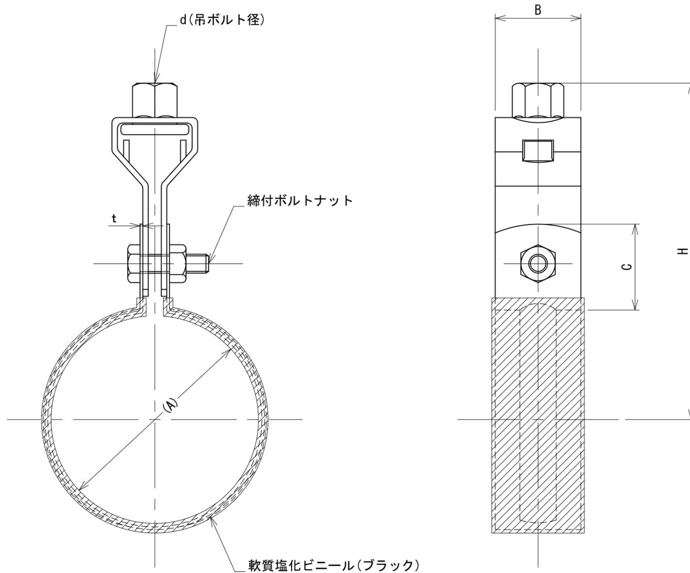
※タンバクル、締付ボルトナットは、電気亜鉛めっき品(材質は鉄製)になります。
