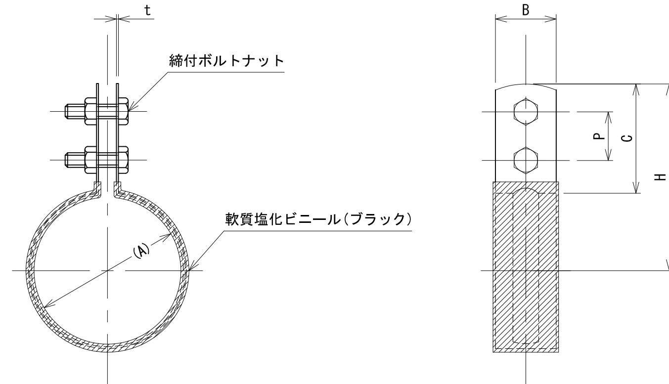
※締付ボルトナットは、鉄製(電気亜鉛めつき)です。
