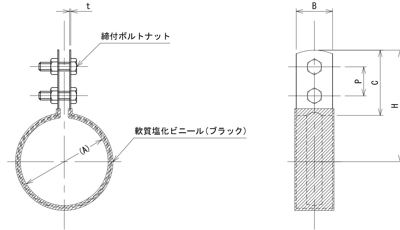
※タンバックル、締付ボルトナットは、電気亜鉛めつき品(材質は鉄製)になります。
